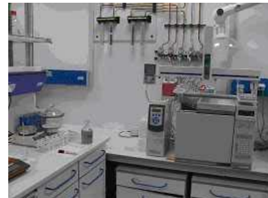
Messplatz zur Bestimmung von Mineralölen /Kohlenwasserstoffen in Wasser
