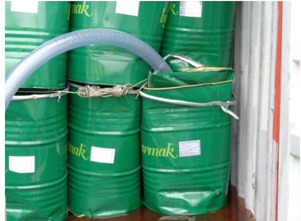
zerdrückte Honigfässer mit Kontamination des Containerbodens
